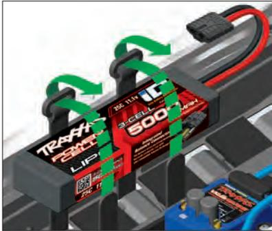
angezogen werden, dass die Batterien nicht verrutschen können, aber nicht übermäßig fest. Wenn Sie die Batterie in einer anderen Position im Batteriefach einsetzen wollen, entfernen sie einfach die Gurte und setzen Sie sie wieder in die zusätzlich mitgelieferten Rinnen ein. Montieren Sie die Gurte wie in der Abbildung gezeigt (es werden NiMH gezeigt, LiPos werden auf die selbe Weise montiert).
